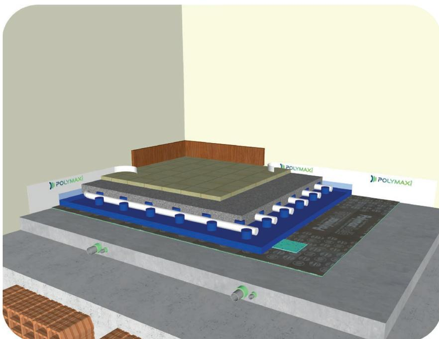
Installare tramite incollaggio o con sistema flottante la pavimentazione di finitura di qualunque tipologia e spessore. Solamente dopo tale operazione si potrà eliminare l'eccedenza della fascia desolarizzante **POLYBAND AD** ed installare il battiscopa. Si consiglia di non posare completamente il battiscopa sulla pavimentazione ma di lasciare una minima lama d'aria e sigillarla con collante elastico.
