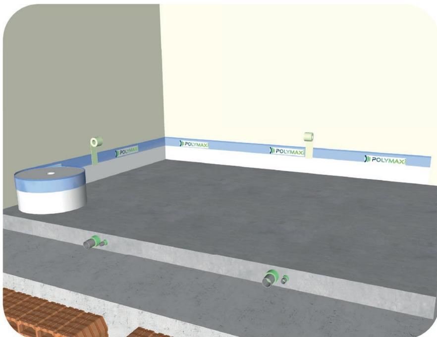
Applicare la parte adesiva della fascia desolarizzante **POLYBAND AD**, eliminando il foglio protettivo, alla base della parete e sostenere con alcuni pezzi di nastro il nylon protettivo che dovrà essere posato sopra al pannello radiante. La fascia va posata con il lato più corto del fissaggio fascia-nylon verso il massetto alleggerito. Tale applicazione deve procedere in modo continuo su tutto il perimetro degli ambienti da trattare.
