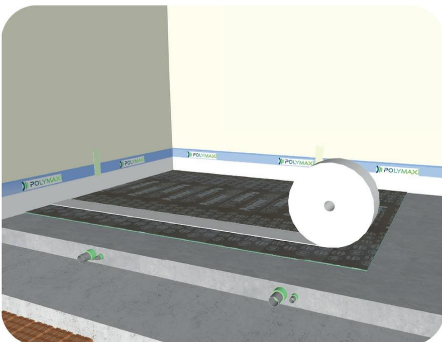
Posare il manto anticalpestio sulla superficie del massetto alleggerito, una volta ripulito da detriti vari di lavorazioni precedenti. Tale manto deve essere posato con bordi ben accostati e sezionato il più possibile a contatto con la fascia perimetrale, in modo tale da evitare pericolosi ponti acustici. Una volta installato il manto acustico su tutta la superficie da trattare, tutte le fughe dovranno essere sigillate in modo uniforme con striscia adesiva **ROTOCELL AD**.
